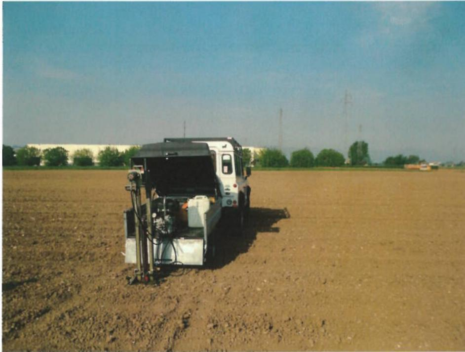
Foto 1 – Esecuzione della prima prova penetrometrica dinamica.
