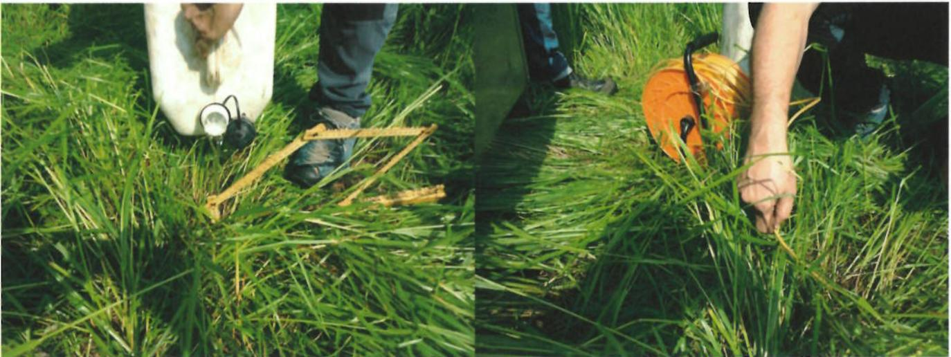
Foto 2 – Esecuzione della prova di permeabilità all'interno del foro della prova penetrometrica DPM 6. A sinistra la fase di saturazione, a destra la fase di acquisizione dati abbassamento/tempo.
